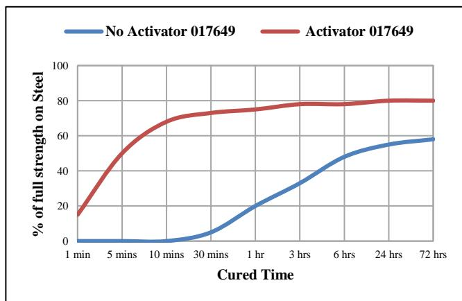
**固化後材料典型性能****膠黏劑性能-扭力**
